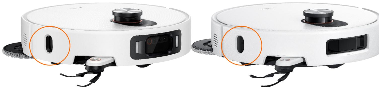
Датчик положения («датчик края»)
