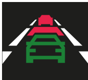
1. sledování nebezpečné blízkosti objektu
