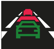
1. відстеження небезпечного зближення з об'єктом
