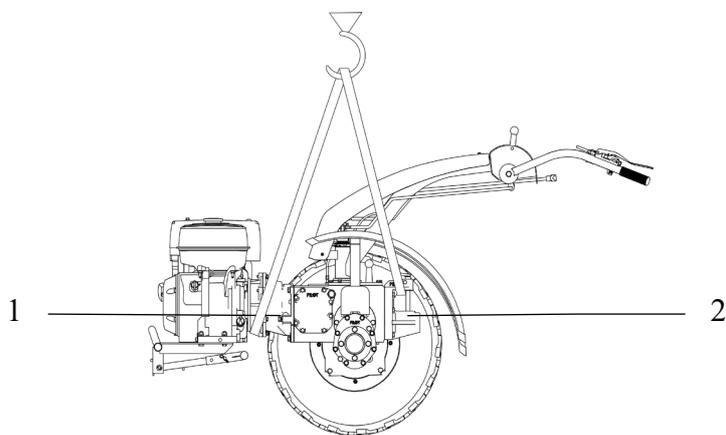
1 – корпус сцепления; 2 – корпус сцепки ВОМ
