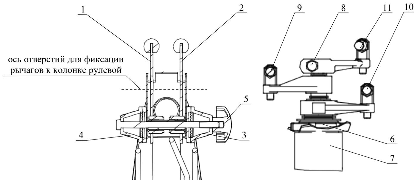
1 – рычаг переключения передач; 2 – рычаг переключения режимов; 3, 4 – рычаги штанги рулевой; 5 - стяжная гайка; 6-шлицевая гайка, 7 - колонка рулевая; 8 - болт; 9 – тяга переключения передач; 10 – тяга переключения режимов; 11 – тяга переключения блокировки дифференциала.
