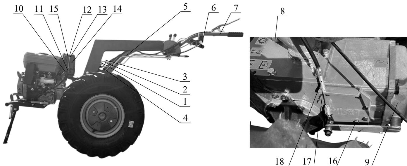
1 - рычаг передач, 2 - рычаг блокировки дифференциала, 3 - рычаг режимов, 4 - гайка шлицевая, 5 - колонка рулевая, 6 – правый рычаг руля, 7 - левый рычаг руля, 8 - пробка, 9 - корпус муфты сцепления, 10 - кронштейн, 11- стяжка, 12 - планка прижимная, 13 - гайка, 14 - аккумуляторная батарея, 15 - пластина, 16 - пробка контрольно-заливного отверстия, 17 - контргайка, 18 - регулировочный винт.
