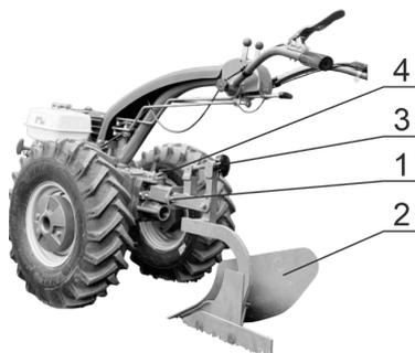
1 – болт, 2 – плуг, 3 – сцепное устройство, 4 – прицепное устройство мотоблока
