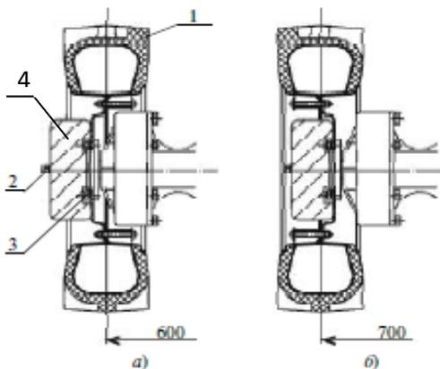
1 - колесо в сборе; 2 - болт крепления балласта; 3 - болты крепления колеса; 4 - балласт;
