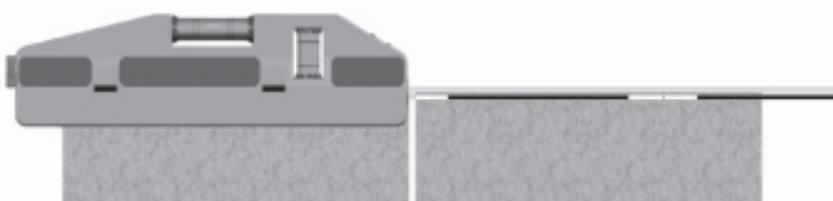
За полагане на плочки на стена уредът се поставя върху първата плочка с помощта на пружинния фиксатор, който може да се избута с щифтовете от задната страна. Лазерният лъч, който преминава успоредно на хоризонталната либела, насочва по продължението на ръба на плочката. По този начин плочката може да се нивелира прецизно с помощта на либелата.
