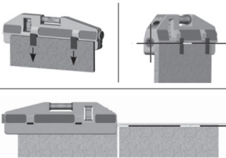
Duvar fayanslarının döşenmesi için cihaz, arka taraftaki kalemler sayesinde dışarı sürülebilir yaylı kıskaçlı sabitleme düzeneği yardımıyla ilk fayansın üzerine takılır. Yatay tesviye ruhuna paralel olarak düşen lazer ışını fayans kenarın boyunca uzanmaktadır. Böylece fayans tesviye ruhu ile kolayca hizalanabilir.
