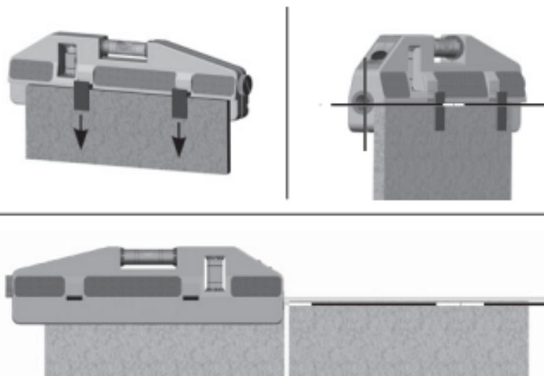
Para assentar azulejos de parede, o aparelho é encaixado no primeiro azulejo, através do suporte de aperto elástico, que pode ser empurrado para fora através dos pinos na traseira. O feixe laser, paralelo ao nível horizontal, é conduzido ao longo da aresta do azulejo. Assim é possível alinhar exactamente o azulejo com o nível.
