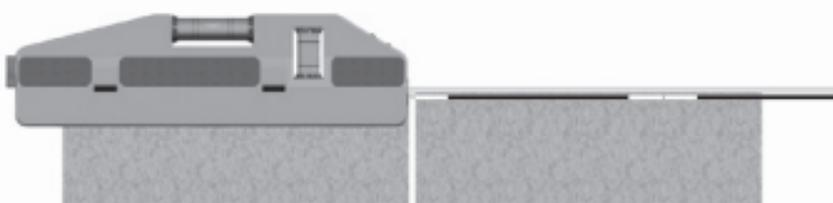
Pro pokládání obkladů se přístroj nastrčí na první obkládačku pomocí pružinového upínacího držáku, který lze vysunout skrz kolíčky na zadní straně. Laserový paprsek, paralelní s horizontální libelou, směřuje podél hrany dlaždice. Dlaždicí tak lze pomocí libely přesně vyrovnat.
