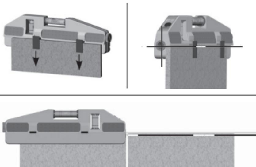
Til opsætning af vægfliser anbringes apparatet med fjeder-fastspændingen – som kan skydes ud gennem stifterne på bagsiden – på den første flise. Laserstrålen, som er parallel med den horisontale libelle, løber langs flisekanten. På denne måde kan man indjustere flisen nøjagtigt med libellen.
