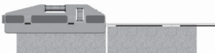
Para la colocación de azulejos se inserta el aparato en el primer azulejo con ayuda de la pinza de sujeción elástica que puede ser retirada mediante las espigas de la parte posterior. El rayo láser, paralelo al nivel horizontal, conduce a lo largo del canto del azulejo. De ese modo se puede alinear el azulejo perfectamente con el nivel.
