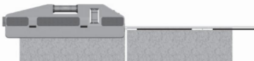
Pour la pose de carrelages muraux, l'appareil est fixé sur le premier carrelage à l'aide de la fixation à pince à ressorts qui se glisse à l'aide des broches sur l'arrière. Le rayon laser parallèle à la bulle horizontale longe le bord du carrelage. Il est ainsi possible d'aligner avec précision le rayon laser avec la bulle.
