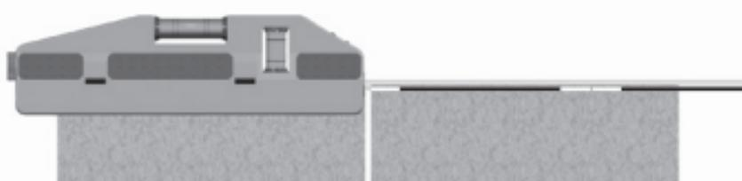
Для укладання стінової керамічної плитки слід встановити прилад за допомогою прижминового затиска, що розсувається за допомогою розташованих ззаду штифтів, на першу плитку. Спямувати лазерний промінь вздовж крайку плитки паралельно поземниці. Це дозволить точно вирівнювати плитки поземницею.
