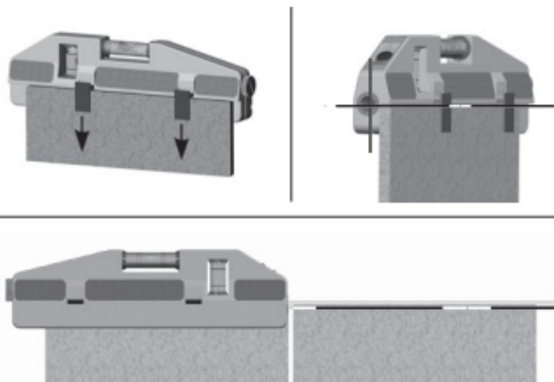
Seinälaattojen asentamista varten laite kiinnitetään ensimmäiseen laattaan jousipuristimella. Jousipuristin työnnetään esiin laitteen takasivulla olevan tapin avulla. Vaakalibellin suuntainen laserviiva osoittaa laatan reunan. Siten laatan voi asentaa tarkasti libellin suuntaisesti.
