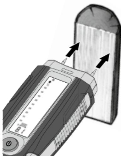
O sítio a medir não deve estar tratado nem deve ter ramos, sujidade ou resina. Não devem ser efectuadas medições em lados frontais, uma vez que a madeira aqui seca particularmente depressa e, dessa forma, levaria a resultados de medição falsos. **Realize várias medições comparativas transversalmente ao veio.**
