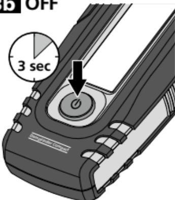
Paristojen säästämiseksi laite kytkeytyy pois päältä 3 min kuluttua. Kytke laitteeseen uudelleen virta ON/OFF-näppäimellä.
