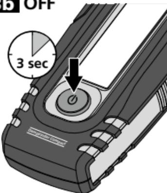
Cihaz 3 dakika sonra pillerin tasarrufu için otomatik olarak kapanır. Cihazı daha sonra tekrar açmak için Açma/Kapama şalterine yeniden basınız.
