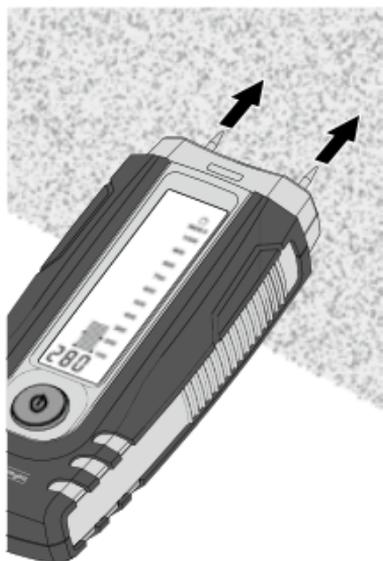
Je třeba mít na paměti, že u stín (ploch) s různým uspořádáním materiálu nebo u různého složení stavební hmoty může docházet k nepřesnému výsledku měření.
