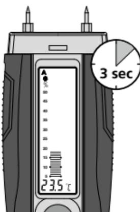
Etter at apparatet er slått på, vises omgivelsestemperaturen i displayet i 3 sekunder.
