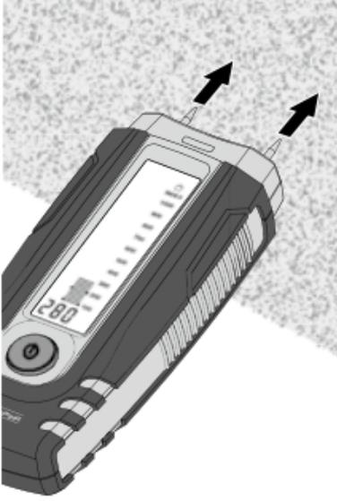
Değişik materyellerden düzenlenerek oluşan duvarlarda (alanlarda) veya yapı malzemelerinin değişik bileşimlerden oluşması durumunda hatalı ölçüm değerlerinin oluşabileceğine dikkat edilmesi gerekmektedir. **Kıyaslama amacı ile birden fazla ölçüm yapınız.**
