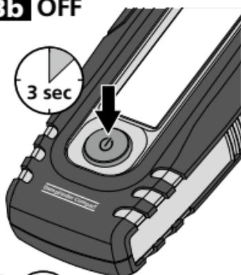
O aparelho desliga-se automaticamente após 3 minutos para poupar as pilhas. Para voltar a ligar o aparelho, carregue novamente no botão para ligar/desligar.
