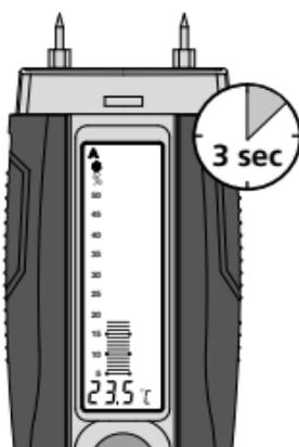
После включения прибора на экране в течение 3 секунд появляются показания температуры окружающей среды.
