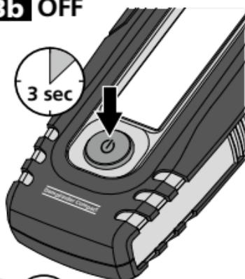
Pro ochranu baterií se přístroj po 3 minutách automaticky vypne. Pro opětovné zapnutí přístroje stiskněte tlačítko zap/vyp.
