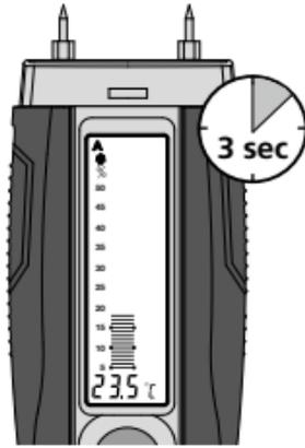
Cihaz açıldıktan sonra ekranda 3 saniyelik bir süre için çevre ısısı gösterilir.
