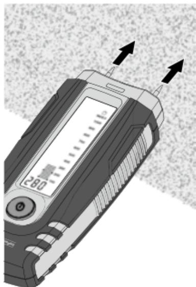
Слід пам'ятати про те, що на стінах (поверхнях) з різним розташуванням матеріалів бо також з різним складом будматеріалів результати вимірювання можуть бути невірними. **Необхідно виконувати декілька порівняльних вимірювань.**
