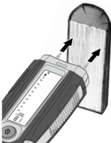
Місце для вимірювання повинне бути неопрацьованим і вільним від гілок, бруду або смоли. Не виконувати вимірювання на торцевих сторонах, тому що деревина тут особливо швидко висихає та таким чином сприяє отриманню помилкових результатів вимірювання. **Виконайте декілька порівняльних вимірювань упоперек волокон.**
