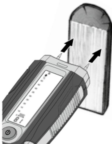
Место замера должно быть необработанным; на нем не должно быть сучков, загрязнений или смолы. Замеры не следует проводить на торцах, т.к. здесь древесина высыхает особенно быстро, а это может привести к искажению результатов измерений. **Выполните несколько сравнительных замеров поперек текстуры древесины.**
