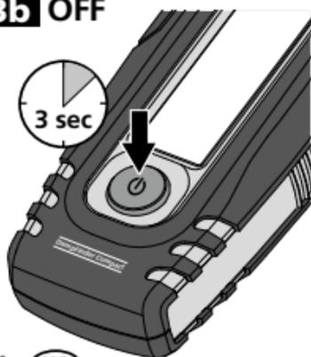
Apparatet slår seg av automatisk etter 3 minutter, for å skåne batteriene. For å slå apparatet på igjen etter dette, trykk på På/Av-bryteren igjen.
