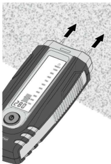
É preciso ter em conta que paredes (superfícies) com uma ordenação de materiais diferente, mas também a composição diferente dos materiais de construção, podem falsificar os resultados de medição. **Efectue várias medições comparativas.**
