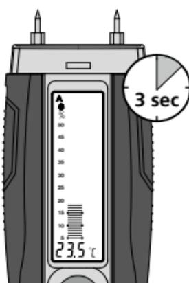
Po zapnutí přístroje se na displeji zobrazí po dobu 3 vteřin okolní teplota.
