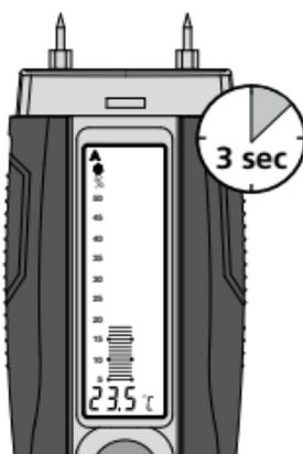
Efter att du har slagit på mätinstrumentet, visas omgivningstemperaturen på displayen i 3 sekunder.
