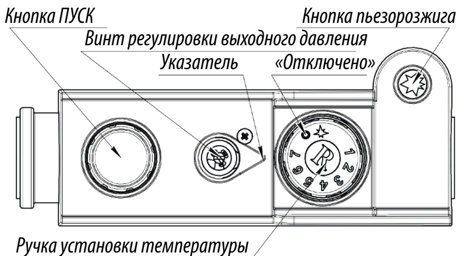
Рисунок 11. Элементы управления на газовом блоке автоматики САБК-ТР
