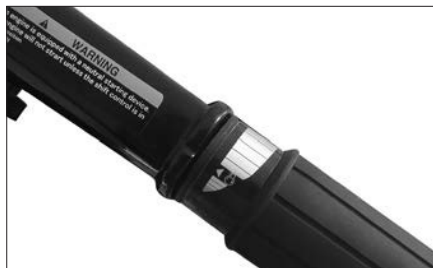
Рис.3 Ручка управления дроссельной заслонкой
