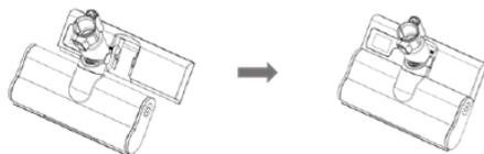
Установите резервуар на корпус моторизованной насадки-щетki.
