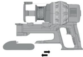
Чтобы установить батарейный блок на корпус пылесоса, нажмите на кнопку установки/снятия батарейного блока и прижмите батарейный блок на его посадочное место.
