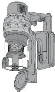
Для обеспечения эффективной работы пылесоса опорожняйте контейнер для сбора пыли после каждого использования. Не допускайте его переполнения.
