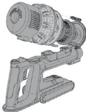
Нажмите на кнопку снятия контейнера для сбора пыли и снимите его с корпуса пылесоса.
