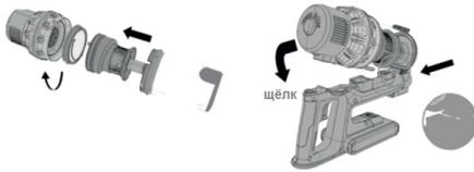
Снова соберите фильтры и установите их обратно в контейнер для сбора пыли, а контейнер установите на пылесос: для этого вставьте крючок в отверстие, а затем прижмите заднюю часть до фиксации, при этом должен раздаться щелчок.
