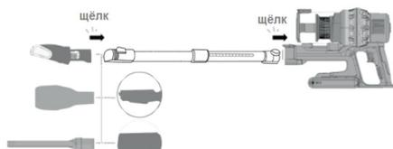
Выровняйте удлинительную трубку относительно воздухозаборной трубки пылесоса и прижмите до щелчка.
