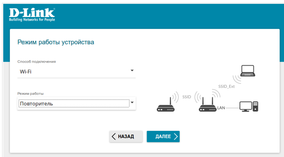
Рисунок 26. Выбор режима работы устройства. Режим Повторитель .
