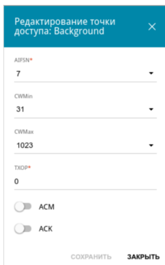
Рисунок 89. Окно для изменения параметров функции WMM.
