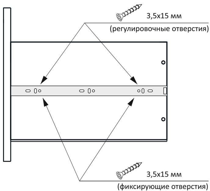
1. Прикрепить съемную часть направляющей на бок ящика шурупами
