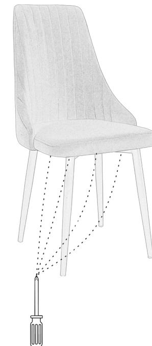
Установите стул на ровную поверхность, убедитесь что все 4 ножки касаются поверхности, затяните винты (A) отверткой.
