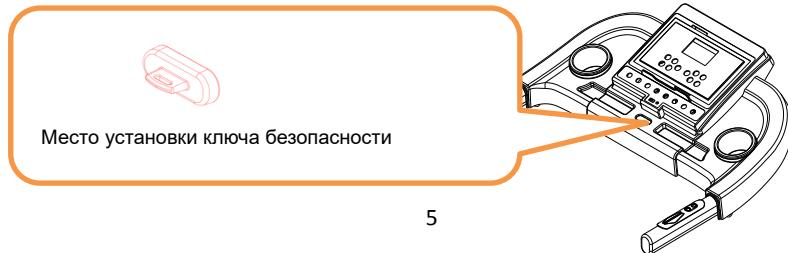
Функция аварийной остановки: при срыве ключа безопасности питание отключается. Эта функция не регулируется с помощью программного обеспечения.
