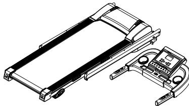
Шаг 2 : Поднимите стойки и медленно потяните их вверх в направлении, указанном стрелкой на рисунке ниже. Далее закрепите их на основании тренажера с помощью винтов F#M8\*40 и D#M8\*16.
