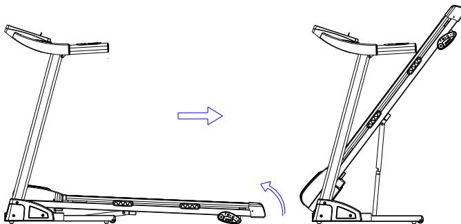
Раскладывание тренажера: Чтобы разложить тренажер, слегка ударьте ногой по зажимному устройству под беговой платформой, как показано на рисунке ниже.
