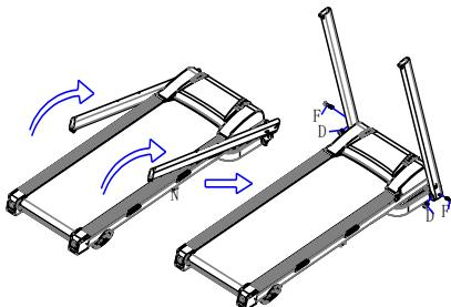
Шаг 3 : Установите компьютер на стойки в направлении стрелки, затем с помощью плоских шайб E#M8 (4шт), винтов D#M8\*16 (2шт) и H# M8\*45 (2шт), а также шестигранных гаек I#M8 (2шт) закрепите компьютер на стойках . Поверните сердечник и корпус компьютера в направлении стрелки согласно рисунку и закрепите его с помощью саморезов с крестообразной головкой K#ST4\*16 и плоских шайб L#.
