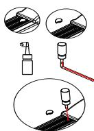
беговую ленту скраю и коснитесь беговой платформы. Если вы почувствуете смазку на поверхности, дополнительно ее добавлять не нужно. Для смазывания используйте масла, не содержащие нефтепродуктов.
