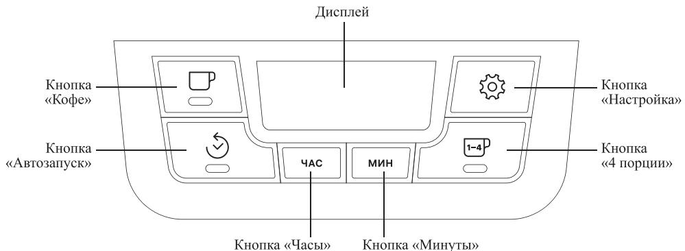
При подключении кофеварки к сети электропитания прибор подаст звуковой сигнал. На дисплее в течение нескольких секунд будет мигать «00:00», затем отобразится время «12:00». Время отображается в 12-часовом формате.
