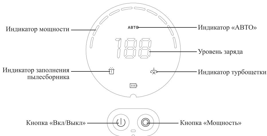
**Кнопка «Вкл/Выкл»** включает и выключает пылесос.
