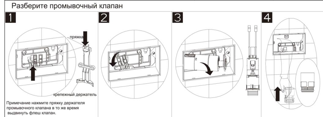
Примечание: В обратном порядке процедура установки является сборкой. Перед сборкой, пожалуйста, тщательно проверьте положение каждого компонента, отрегулируйте или замените его.
