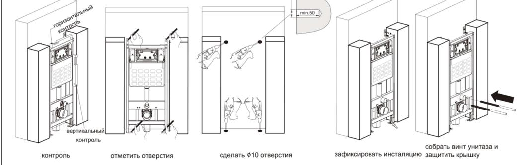
Примечание: единица измерения - миллиметры. Давление воды заполнения и остановка давления наполнения находится между 0.01MPa-2.0MPa, температура воды: 2°C-45°C.
