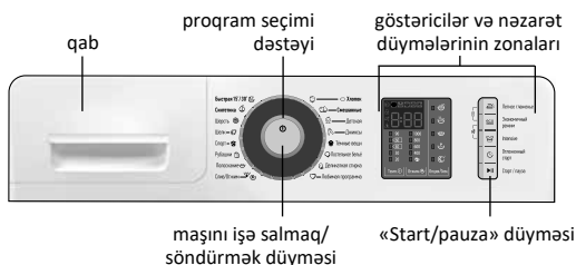
Şəkil 1 – İdarəetmə paneli
