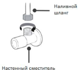
Вариант 1. Подключается к крану (через угловой клапан).
