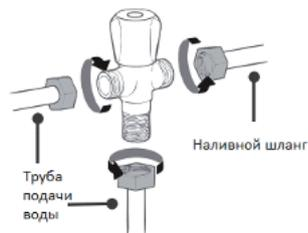
Вариант 2. Подключение с помощью трехходового клапана (через два конца соединения водяного шланга)
