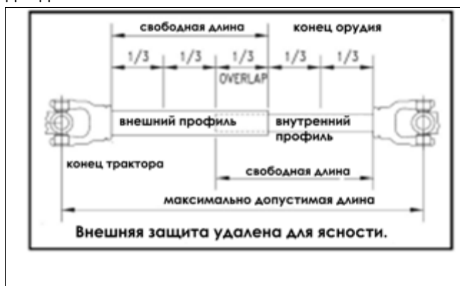
Максимальная увеличенная длина карданного вала Рисунок 1-4
