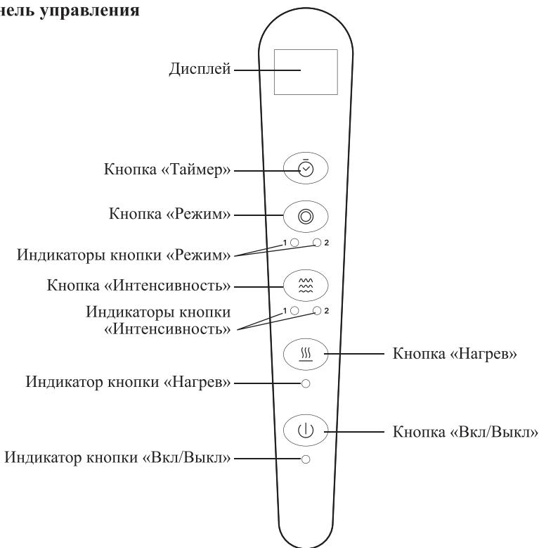
После подключения к сети прибор перейдет в режим ожидания — **индикатор кнопки «Вкл/Выкл»** будет медленно мигать. Чтобы включить массажер, нажмите один раз на **кнопку «Вкл/Выкл»**, на дисплее отобразится время работы по умолчанию.
