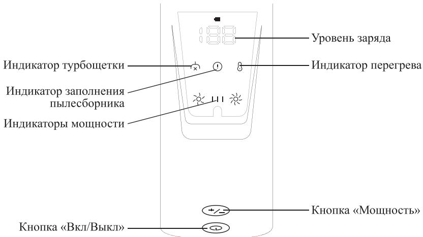
**Кнопка «Вкл/Выкл»** включает и выключает пылесос.
