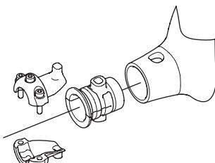
Проверьте, чтобы амортизатор был в целости и хорошо закреплен.
