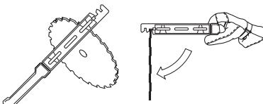
Проверьте режущее оборудование на наличие повреждений или трещин. Поврежденное
