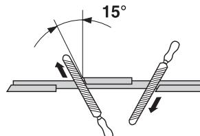
Отрегулируйте разводку. она должна составлять 1 мм.
