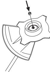
При сборке надо затягивать гайку против направления вращения режущего оборудования. При разборке надо отвинчивать гайку в направлении вращения режущего оборудования. (ЗАМЕЧАНИЕ! Гайка имеет левостороннюю резьбу.) Затяните гайку торцевым гаечным ключом.
