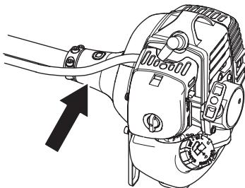
Неправильно закрепленая леска или незаточенное, неправильное режущее оборудование (не соответствующий тип или неправильно заточенные, см. раздел Затачивание лезвия) способствуют увеличению вибрации.
