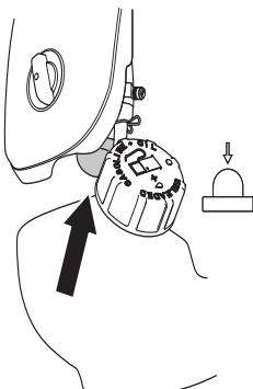
Заслонка топлива: Установите заслонку топлива в положение закрыто.
