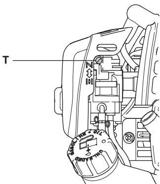
**ПРЕДУПРЕЖДЕНИЕ!** Если холостые обороты невозможны отрегулировать так, чтобы режущее оборудование стояло неподвижно, обращайтесь к продавцу/в мастерскую. Не пользуйтесь машиной, пока не будет выполнена точная регулировка или ремонт.
