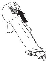
Запустите двигатель и проверьте, чтобы он остановился при переводе выключателя в положение стоп.
