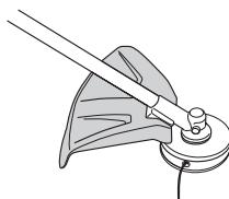
Проверьте, чтобы защита не была повреждена и чтобы на ней не было трещин. Замените защиту, если она была подвергнута удару или если на ней есть трещины.
