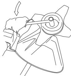
Нейлоновая прокладка конгрейки не должна быть изношена настолько, чтобы ее можно было поворачивать вручную. Прокладка должна выдерживать усилие минимум 1,5 Нм. Гайку следует заменить после ее использования приблизительно 10 раз.
