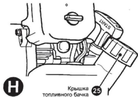
Откройте крышку топливного бачка (25).
