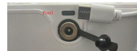
Порт 1 предназначен для зарядки type-C и заряжается с помощью белого кабеля для передачи данных.
