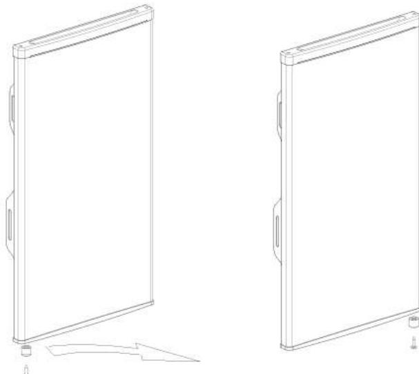
5) Установите дверь на нижнюю петлю в сборе, затем последовательно установите верхнюю петлю, крышку петли, штифты и заглушку отверстия.
