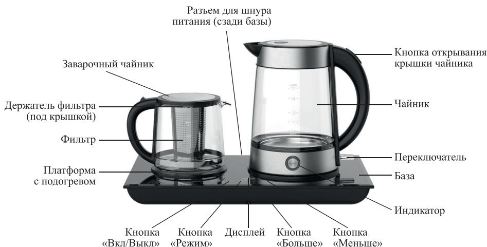
**Переключатель** включает чайник в нижнем положении и останавливает кипячение в верхнем положении. Во время работы чайника горит подсветка и **индикатор**.
