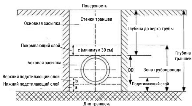
РИС. 3. УСТРОЙСТВО ТРАНШЕИ
