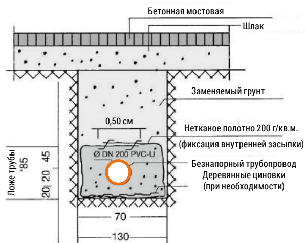
РИС. 7. ПРИМЕР ПРОКЛАДКИ ТРУБ В МЯГКОМ ГРУНТЕ
