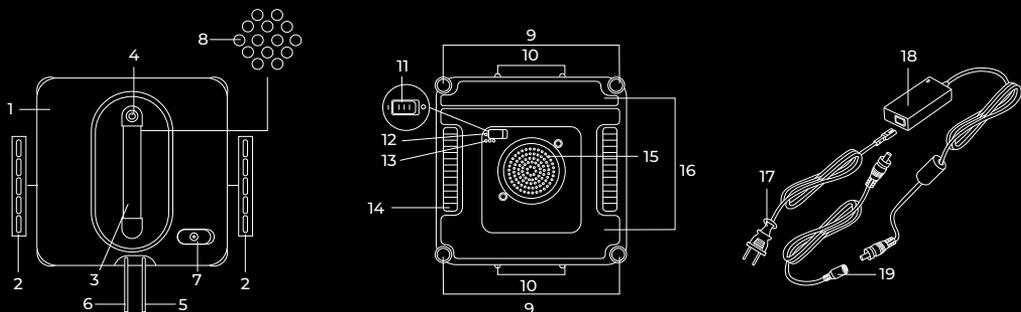
1. Корпус с резервуаром для воды
