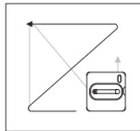
Прибор будет сначала двигаться по траектории N, автоматически распознавая препятствие, меняя свое направление и подавая воду из форсунок (10). А после по траектории Z, также автоматически распознавая препятствие и меняя свое направление, но без подачи воды из форсунок.
