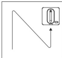
Прибор будет подавать воду из форсунок (10), двигаться по траектории N, автоматически распознавая препятствие и меняя свое направление.
