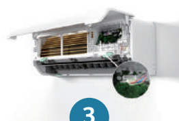
3 Снимите крышку с блока управления, отсоедините кабели вентилятора и двигателя вертикальных жалюзи
