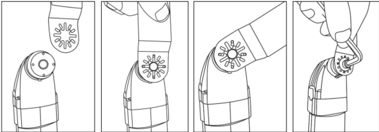
Насадку можно установить под любым необходимым для работы углом и в любом положении (если это насадка для шлифования). После выбора положения, закрепите насадку на шпинделе с помощью шайбы, винта крепления и шестигранного ключа.
