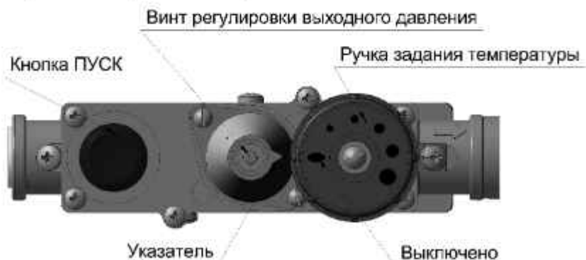
Рисунок 5 - Элементы управления на газовом блоке автоматики САБК-Т.
