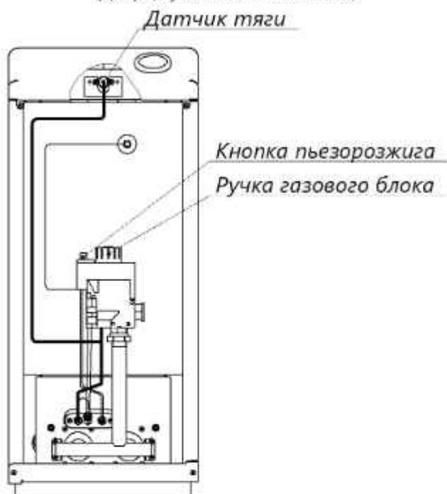
Рисунок 4 - Особенности котла с газовым блоком 630 EUROSIT
