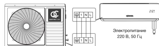
Электрическая схема QN-M18...24WAE/QV-M18...24WAE
