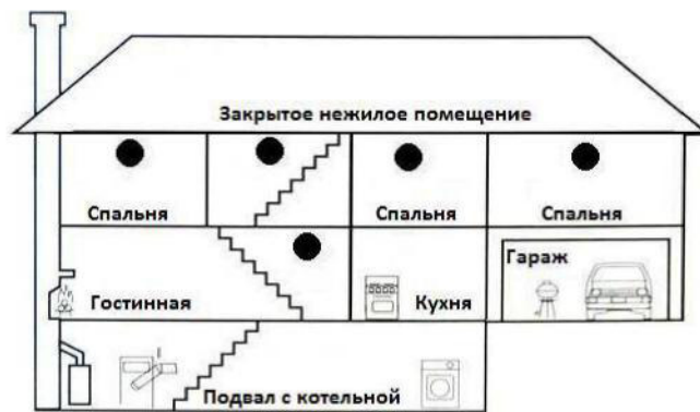
● Основные места установки сигнализаторов газа
