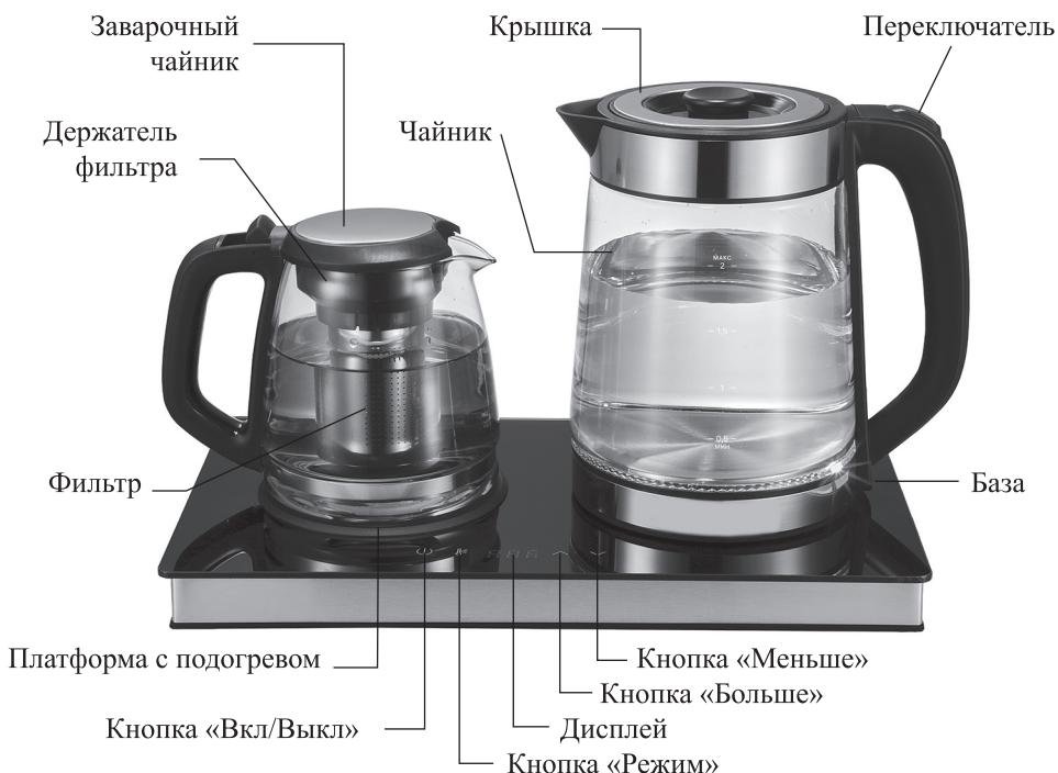
**Переключатель** включает чайник в положении «I» и останавливает кипячение в положении «O».
