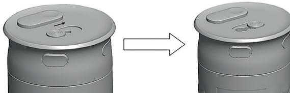
Вставьте насадку в отверстие для насадки до упора.
