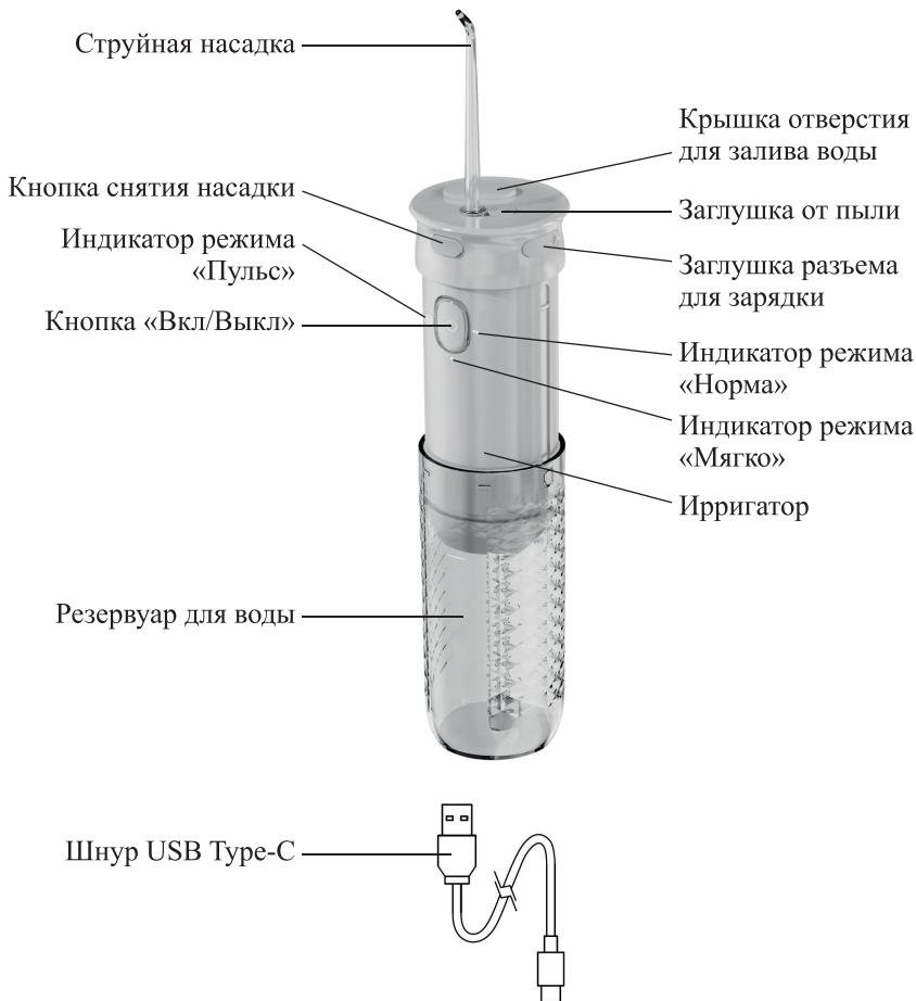
**Кнопка «Вкл/Выкл»** включает, циклически переключает три режима и выключает работу ирригатора. При этом загорается соответствующий **индикатор**.
