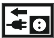
Перед заменой лампы необходимо отключить электропитание. В случае стационарной установки цепь питания должна быть оборудована отключающим устройством (например, автоматическим выключателем).
