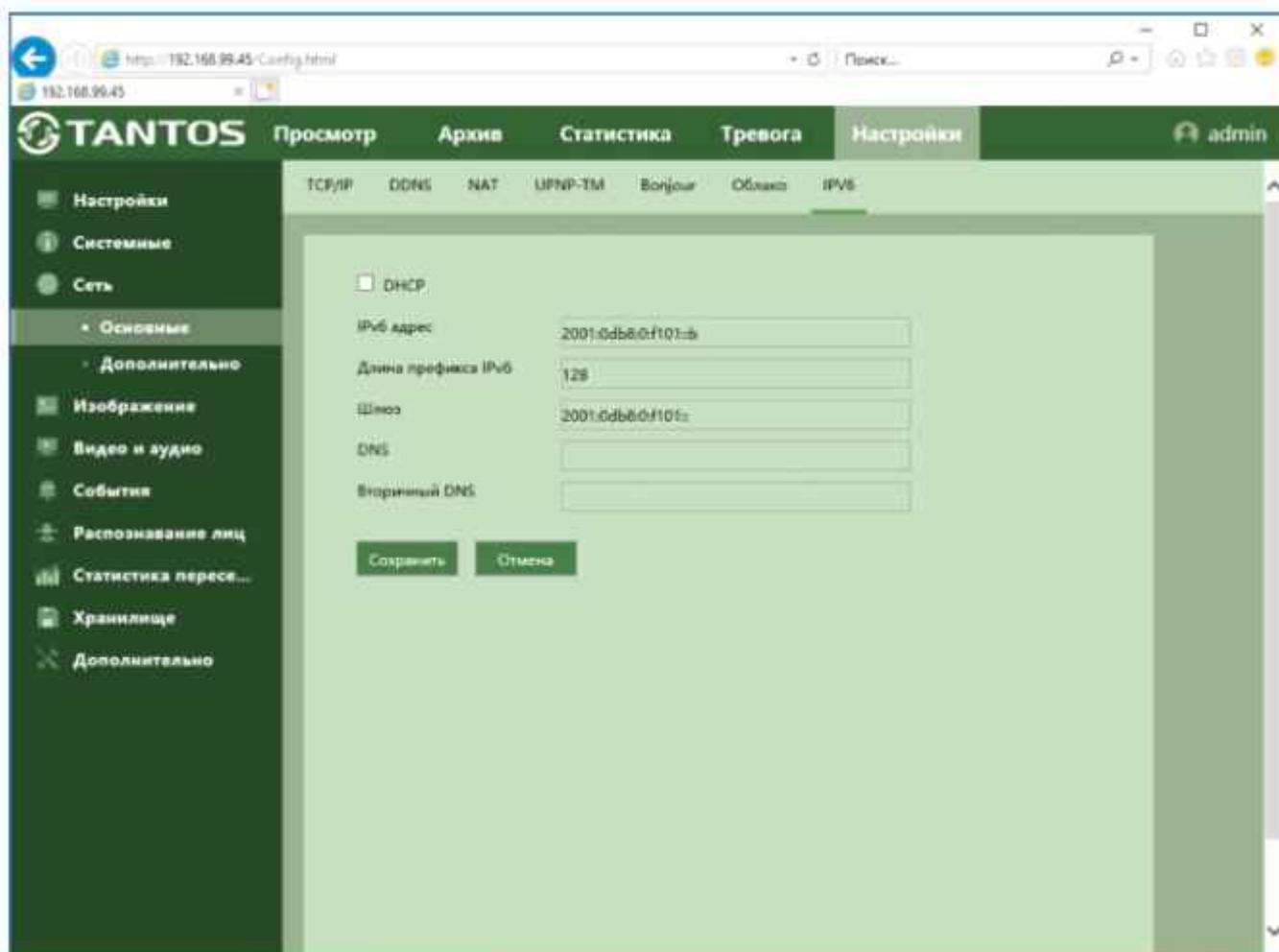
Протокол IPv6 (Internet Protocol version 6) — это новая версия интернет протокола (IP), созданная с целью решения проблем, с которыми столкнулась предыдущая версия (IPv4) при её использовании в интернете, одна из которых – это использование длины адреса 128 бит вместо 32. Количество IP адресов IPv4 ограничено и большинство их уже занято. Количество адресов IPv6 практически неограничено.
