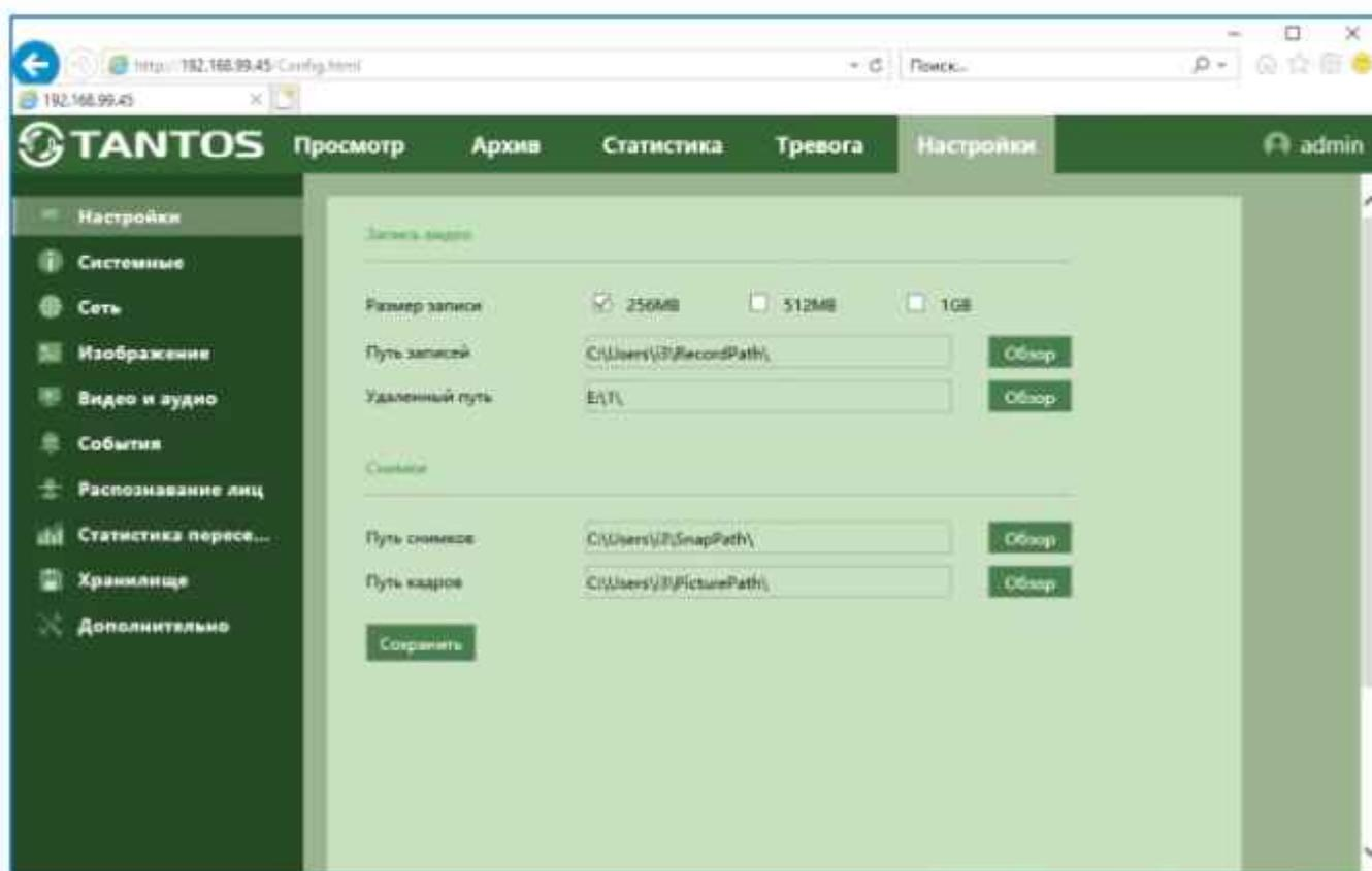
**Размер записи** – максимальный размер записываемых файлов. Файлы большего размера разбиваются на более мелкие.
