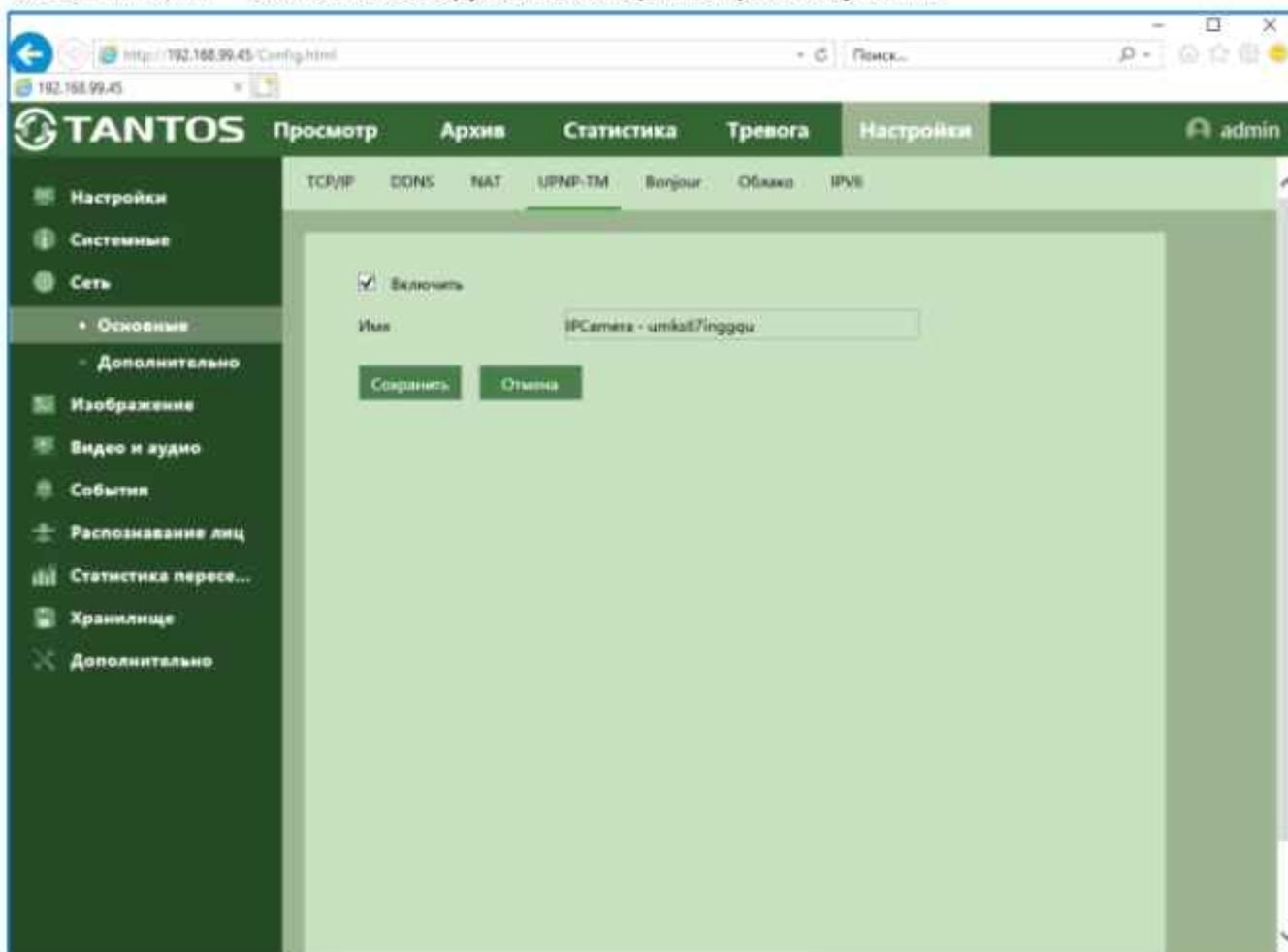
Технология UPnP (Universal Plug and Play) позволяет персональным компьютерам и интеллектуальным сетевым системам соединяться между собой автоматически и работать совместно через единую сеть. Платформа UPnP строится на основе таких интернет - стандартов, как TCP/IP, HTTP и XML. Поддержка UPnP реализована в операционных системах Windows.
