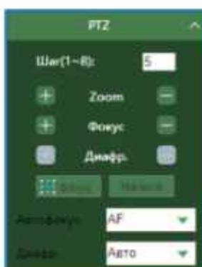
Меню **Управление PTZ** позволяет оперативно управлять поворотными камерами и камерами с моторизованным объективом.
