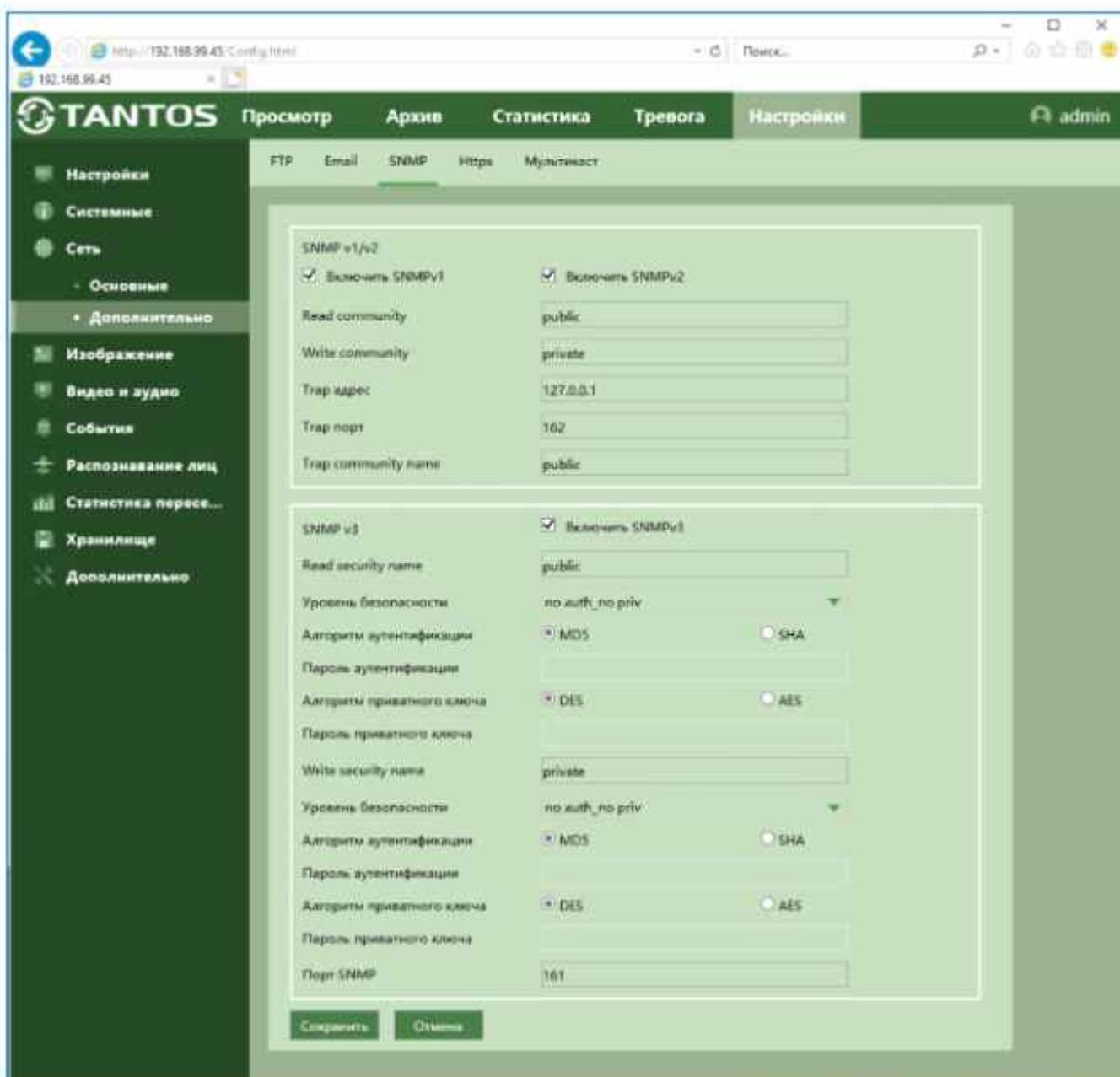
**SNMP** (Simple Network Management Protocol) — протокол, который используется для управления сетевыми устройствами. С помощью протокола SNMP, программное обеспечение для управления сетевыми устройствами может получать доступ к информации, которая хранится на управляемых устройствах (например, IP камере или видеорегистраторе). На управляемых устройствах SNMP хранит информацию об устройстве, на котором он работает, в базе данных, которая называется MIB.
