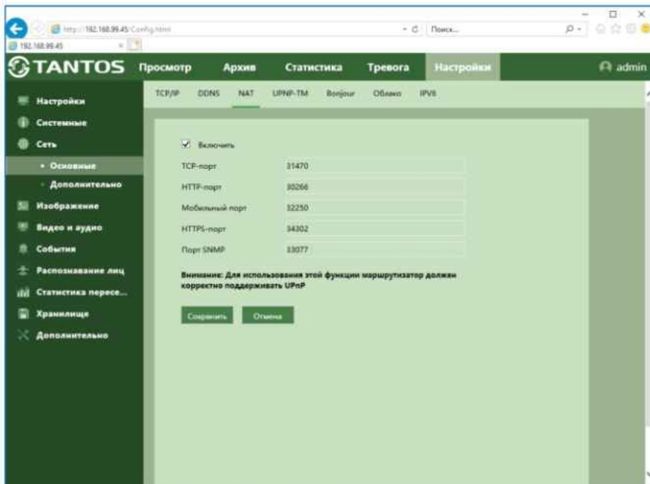
При поддержке роутером данной функции для того, чтобы обратиться к камере из Интернет (при условии, что сам маршрутизатор имеет выделенный статический IP адрес), достаточно просто включить в роутере поддержку UPnP, включить трансляцию портов через NAT в устройстве. При этом маршрутизатор сам будет транслировать через NAT обращение из Интернет к камере на соответствующие порты.
