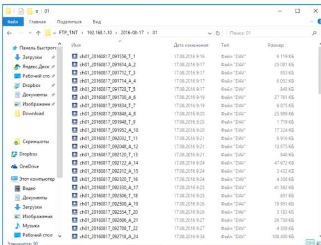
Камера записывает видеофайлы на FTP сервер в специфическом формате, совместимом с многоканальным форматом записи видеорегистраторов, поэтому для чтения файлов необходимо использовать ПО **TS VMS** или плеер **vPlayer** из комплекта поставки камеры.
