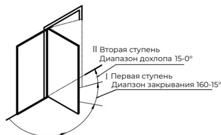
1. Регулировка скорости закрывания производится винтами клапана №1 (скорость закрывания доводчика в диапазоне от 160° до 15°). При повороте против часовой стрелки скорость увеличивается, при повороте по часовой стрелке скорость уменьшается.
