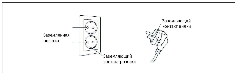
Рисунок 59 — Правильное заземление массажного кресла
