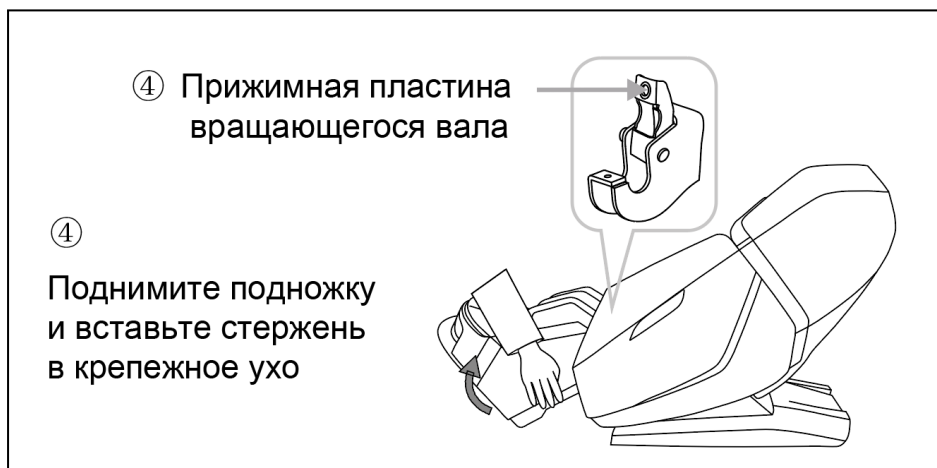
Рисунок 19 — Установка секции для ног
