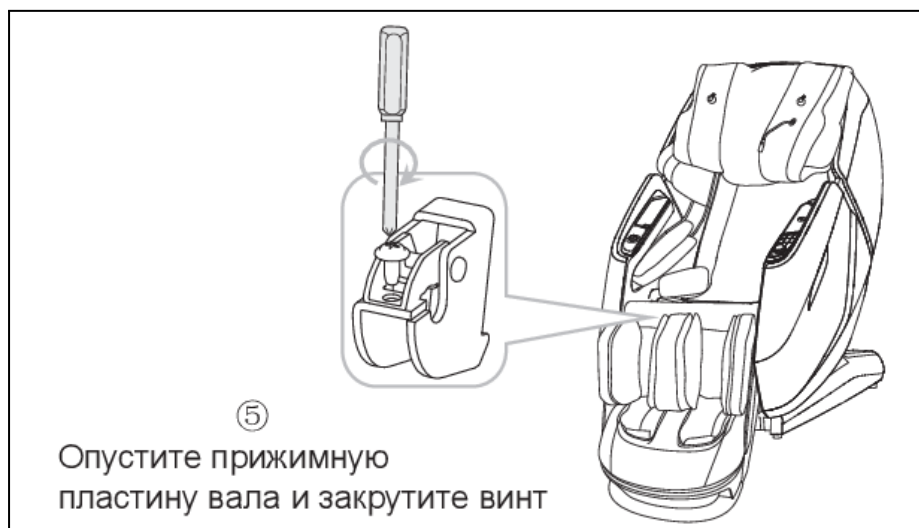
Рисунок 20 — Установка секции для ног
