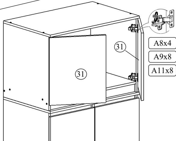
Двери фиксируются на корпус антресоли при помощи шурупов А9, после чего производится регулировка дверей.
