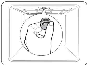
1. Снимите стеклянный колпачок, повернув его против часовой стрелки.
