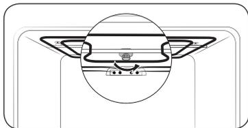
1. Опустіть нагрівальний елемент гриля. Для цього поверніть муфту проти годинникової стрілки, тримаючи нагрівальний елемент гриля. Нагрівальний елемент гриля не є знімною частиною. Не тисніть нагрівальний елемент гриля донизу із силою.
