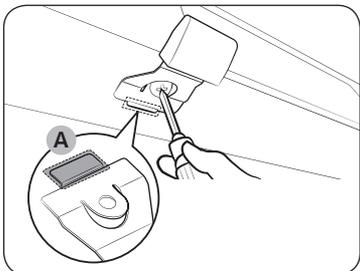
1. Вставьте тонкую часть **(A)** механического замка в соответствующий паз на ручке, как показано на иллюстрации.
