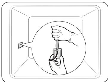
1. Возьмитесь за нижнюю часть плафона лампы, расположенной на боковой стенке камеры духового шкафа, и снимите его, помогая себе плоским заостренным предметом, например ножом.
