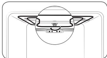
3. После завершения очистки установите нагревательный элемент гриля на место и заверните гайку в направлении по часовой стрелке.
