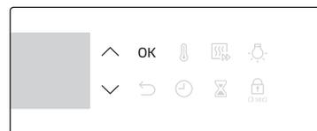
5. Порция мөлшерін орнату үшін  $\wedge$  /  $\vee$  түймешіктерін пайдаланып, содан кейін пісіре бастау үшін **OK** түймешігін басыңыз.
