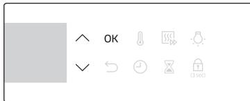
2. За допомогою кнопок **Λ / V** виберіть програму, тоді натисніть **OK**. Відобразиться доступний діапазон ваги (розмір порції).
