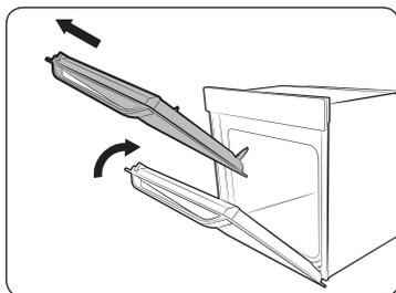
2. Прикройте дверцу на угол примерно 70°. Удерживая дверцу духового шкафа с двух сторон, поднимите и потяните ее вверх до тех пор, пока петли полностью не выйдут из отверстий.
