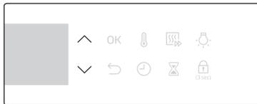
2. За допомогою кнопок  $\wedge$  /  $\vee$  встановіть температуру.
