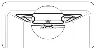
1. Опустите нагревательный элемент гриля. Для этого, удерживая нагревательный элемент гриля, отверните круглую гайку, вращая ее против часовой стрелки. Нагревательный элемент гриля не является съемной деталью. Не прикладывайте усилий, чтобы опустить нагревательный элемент гриля.
