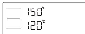
Духовой шкаф начинает предварительный прогрев. Предварительный прогрев завершается, когда температура внутри духового шкафа достигает заданного значения. Предварительный прогрев духового шкафа рекомендуется выполнять во всех режимах приготовления, кроме отдельных случаев, указанных в руководстве по приготовлению.
