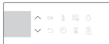
2. За допомогою кнопок  $\wedge$  /  $\vee$  змініть час завершення на поточний час. Або просто натисніть
