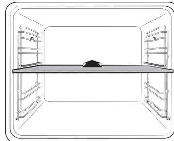
Установите разделитель на уровне 3, чтобы разделить внутреннее пространство духового шкафа на две зоны. Духовой шкаф автоматически определяет наличие разделителя и по умолчанию включает верхнюю зону.
