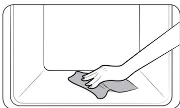
4. Протрите внутренние поверхности духового шкафа сухой тканью.
