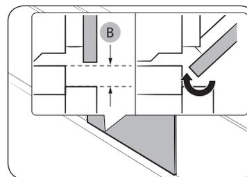
Также оставьте зазор не менее 3 мм (B), чтобы дверца легко открывалась и закрывалась.
