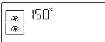
Духовой шкаф начинает предварительный прогрев. Предварительный прогрев завершается, когда температура внутри духового шкафа достигает заданного значения. После завершения предварительного прогрева воспроизводится звуковой сигнал и индикатор перестает отображаться на дисплее. Предварительный прогрев духового шкафа рекомендуется выполнять во всех режимах приготовления, кроме отдельных случаев, указанных в руководстве по приготовлению.
