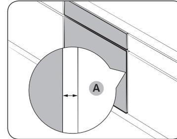
Упевніться, що між пристроєм та кожною стороною шафи залишено зазор (A) принаймні 5 мм.
