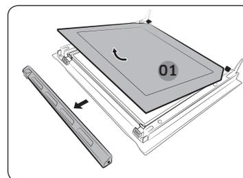
2. Снимите крышки, сдвинув их в направлении, указанном стрелкой.
