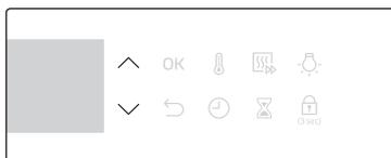
2. Пісіру уақытын "00:00" қалпына қою үшін  $\wedge$  /  $\vee$  түймешіктерін пайдаланыңыз. Немесе түймесін басуға да болады.
