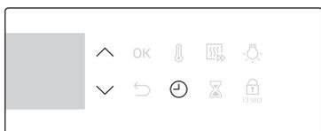
2. Дважды нажмите
