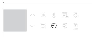
Щоб змінити поточний час після початкового налаштування, натисніть і утримуйте кнопку **⌚** упродовж 3 секунд, тоді виконайте вказівки вище.
