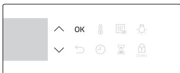
2. Выберите программу с помощью кнопок **Λ / V**, а затем нажмите **OK**. Отобразится доступный диапазон веса (размера порции).
