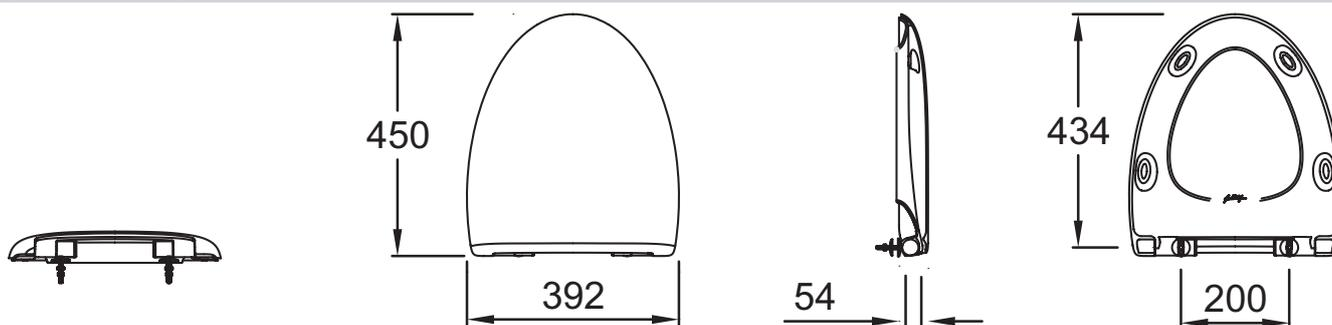
Спецификация продукта: Крышка-сиденье из термодюра. E70021. Коллекция: PATIO. РАЗМЕРЫ (CM): 45 x 39,20 см. ВЕС: 1,9 кг. МАТЕРИАЛ: Термодюр. АКССУАРЫ: Стандартная крышка-сиденье. ТИП КРЫШКИ-СИДЕНЬЯ: Съемная с механизмом "плавное опускание". Шарниры из нержавеющей стали.
