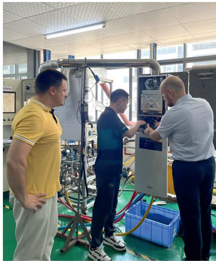
•• Стресс-тест функционирующего котла
