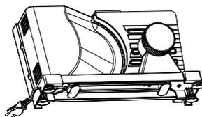
2. Прокрутите ручку против часовой стрелки, вставьте направляющую в направляющее отверстие стола подачи, затем нажмите на направляющую, чтобы вернуть её в паз кнопки.
