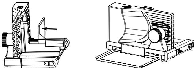
8. Нажмите кнопку освобождения и одновременно переверните нижнюю пластину, чтобы сложить устройство.
