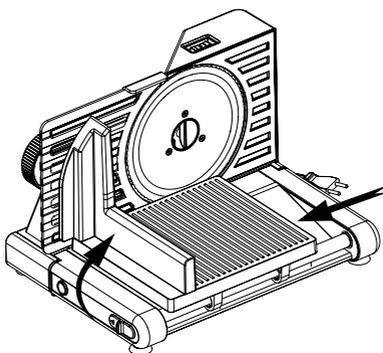
3. Поверните ручку ножа вправо, снимите лезвие, промойте его с использованием мощющего средства и вытрите насухо.
