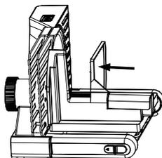
7. Установите переключатель на 2-ю скорость (переключатель на 1-ой скорости – нормальная работа, 2-я скорость – шаговый режим, 0-я передача – остановка). Слегка надавите на продукт прижимной пластиной и перемещайте стол подачи назад и вперед между режущими дисками, пока продукт не будет полностью нарезан на кусочки.
