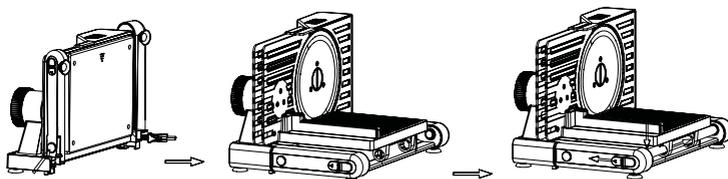
3. Снимите лоток с нижней части устройства и установите его на выходе.
