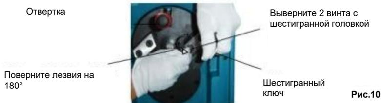
Если обе режущие кромки лезвия износились, их следует заменить в паре. Лезвия можно заточить заново, но это должен делать опытный специалист с использованием масляного камня. Мы не рекомендуем этого делать, поскольку вес каждого лезвия имеет решающее значение для поддержания баланса отрезного круга. Любой дисбаланс может привести к повреждению машины и возможным травмам оператора.
