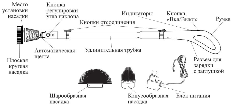
**Кнопка «Вкл/Выкл»** включает щетку на низкой скорости работы, переключает скорость на высокую и выключает щетку.
