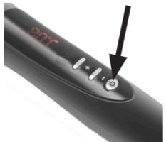
5. À l'aide de la touche (+) [4] ou la touche (-) [5], vous pouvez régler le niveau de température souhaité. Le niveau actuel de température s'affiche sur l'affichage de la température sur écran LCD [3]. Une double pression sur la touche MARCHE/ARRÊT [6] permet de régler la température de manière fixe. Le symbole de cadenas s'affiche à l'écran. Nous recommandons les réglages de température suivants :
