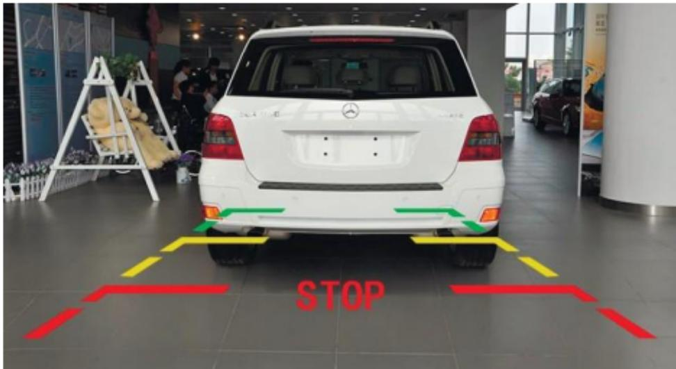
При правильной установке и подключении камеры заднего вида, изображение с парковочными линиями выводится на дисплей устройства автоматически при включении задней передачи.
