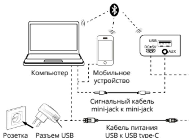
Рис. 2. Схема подключения
